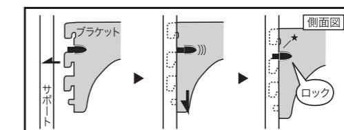
※ブラケットを外す時は、抜け止めの左側を手前で引き自動ロックを解除してください。
