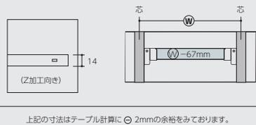
注) 縦パイプ両端に回転止めの欠き取り加工があるため、スリットの向き変更(外側への回転や90°回転)はできません。(要オプション加工)
