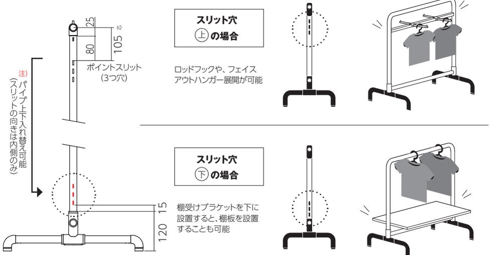
注) 縦パイプ両端に回転止めの欠き取り加工があるため、スリットの向き変更(外側への回転や90°回転)はできません。(要オプション加工)
