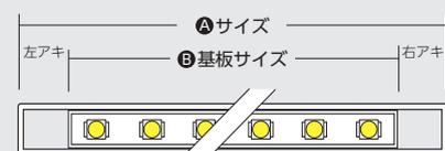
$(A \text{ サイズ} - B \text{ 基板サイズ}) \div 2 = \text{片側アキ寸法}$
