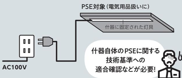
灯具が電気用品の場合、什器に灯具を固定すると什器自体が電気用品の対象に!
