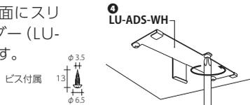
2 スリムアダプタ (LU-ADS) の溝にツメを挿し込んでからスリムアダプタを取り付け、メガネ型コード (LU-MC) を挿し込みます。
