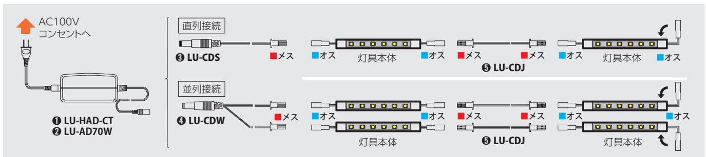
⚠ 使用する各灯具のページで、サイズのワット数を確認し、使用灯数を掛けて総ワット数を求めてください。(ワット数×灯数=総ワット数)
