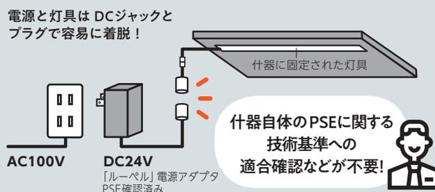
ルーペルは灯具に電源がなくアダプタ (変換機) を通して接続するシステムのため、電源とアダプタ及びアダプタと灯具が簡単に脱着でき、電気用品の対象にはなりません。
