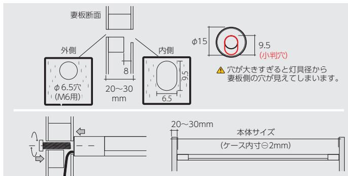
ケーブルを先に通してから、灯具本体と妻板を付属ボルトで挟み込むように取り付けてください。
