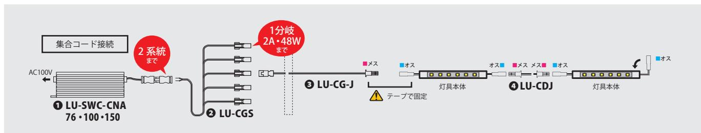
⚠ 使用する各灯具のページで、サイズのワット数を確認し、使用灯数を掛けて総ワット数を求めてください。(ワット数×灯数=総ワット数) 総ワット数は、電源の許容範囲内で灯具を連結してください。(最大出力電力の70%)
