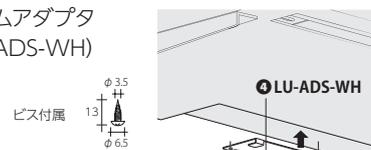
2 スリムアダプタ (LU-ADS) の溝にツメを挿し込んでから取り付けます。
