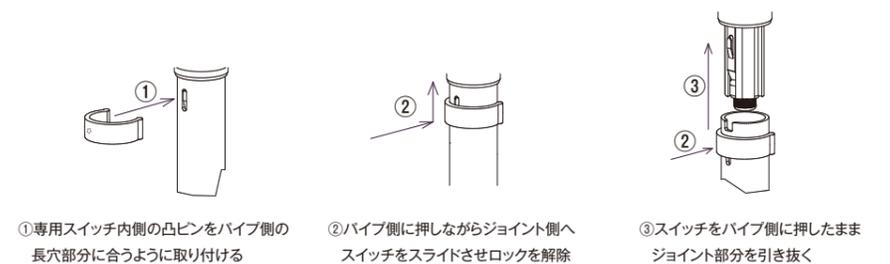
①専用スイッチ内側の凸ピンをパイプ側の長穴部分に合うように取り付ける
